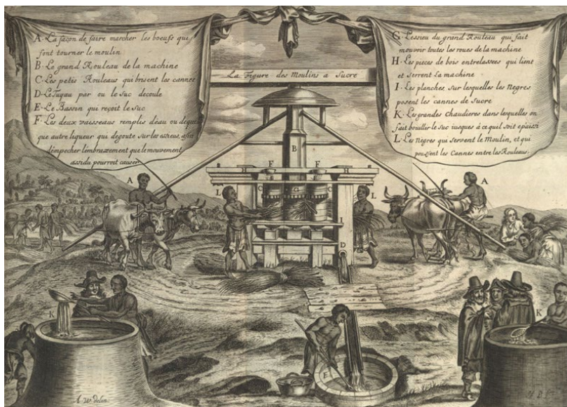
Citation: Sugar mill with vertical rollers, French West Indies, 1665. [Charles de Rochefort, Histoire naturelle et morale des iles Antilles de l'Amérique ... (Rotterdam, 1681), p. 332]
