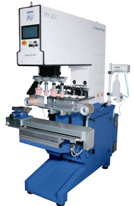
Tamponreinigung und Tamponverschie- bevorrichtung an TPX 300 Pad cleaning device and pad sliding device on TPX 300
