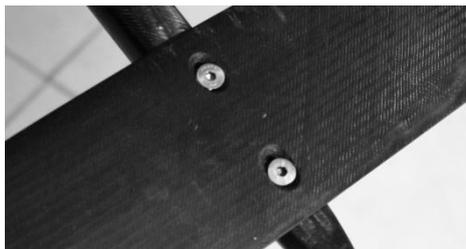
Les trous oblongs sur l'aile arrière permet de régler le V longitudinal du foil. Il permet de régler la pression à appliquer sur la jambe arrière pour décoller en fonction du vent et de la voile utilisée. Vous noterez qu'un témoin moulé dans la masse à coté de la vis avant permet de connaitre ses réglages d'une session sur l'autre.
