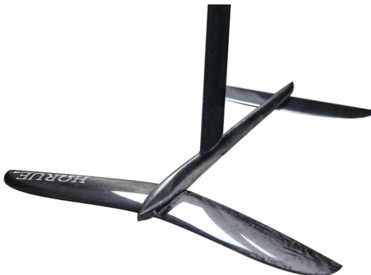
Le montage du foil dans le boîtier de la planche de windsurf débute par l'insertion du boîtier deep tuttle du foil dans le boîtier femelle de la planche. Enfoncez le au maximum à la main, il se peut que quelques millimètres sortent alors de la carène. La butée de carène « plug and play » doit être en place avant l'insertion.
