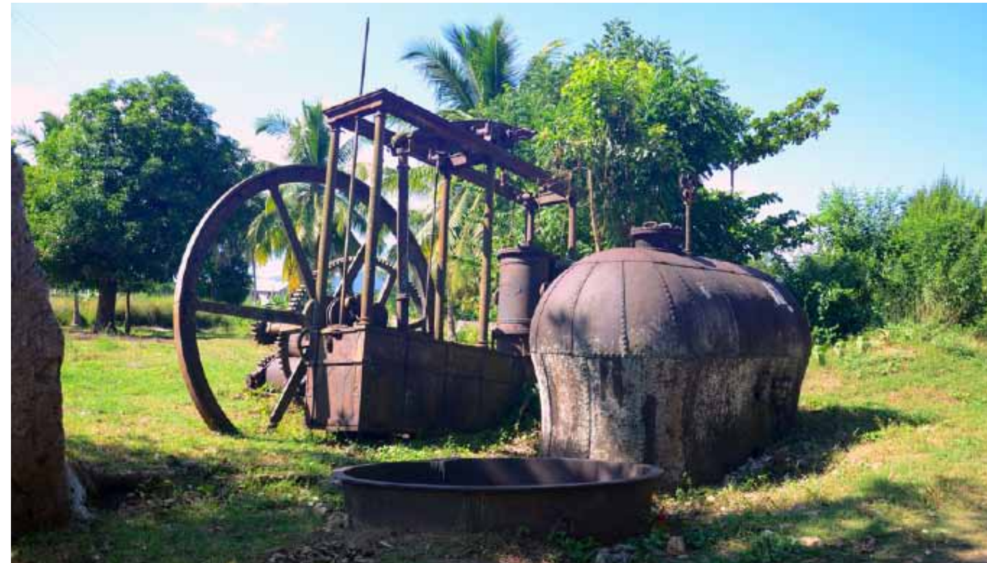
• Le moulin Price : à g., le volant d'inertie, au c., le chassis, le cylindre et la citerne de condensation et à d., la chaudière. En avant-plan, une cuve.
