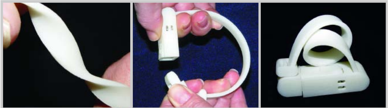
Steckverbinder mit Schnappverschlüssen weisen eine erstaunliche Zähigkeit auf, wenn sie häufigem Biegen und Drehen ausgesetzt sind.
