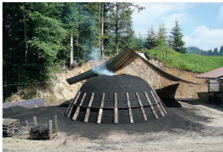
Der fertige, mit Reisig- und Löschimantel abgedichtete Holzkohlemeiler in Aktion.
