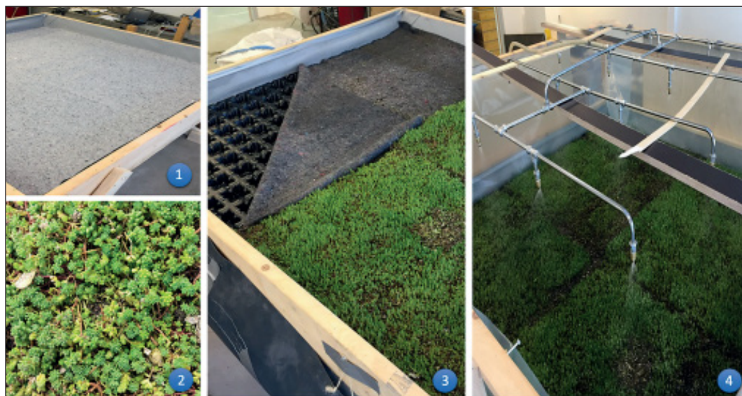
Figur 7. Laboratorieoppsett for å måle avrenningskoeffisienter etter standardmetode. Foto: Lotte Askeland Schärer.
