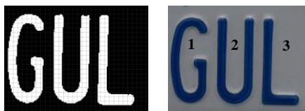
Figura 7. Ejemplo de Etiquetado de componentes conectados.
