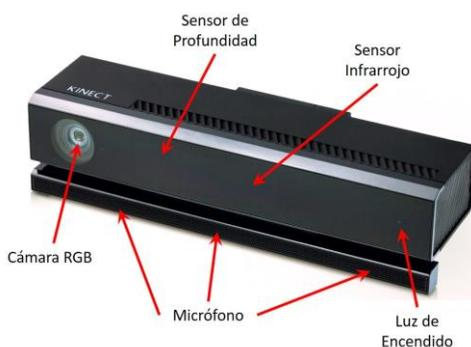
Figura 2. Componentes básicos de Microsoft Kinect v2.0
