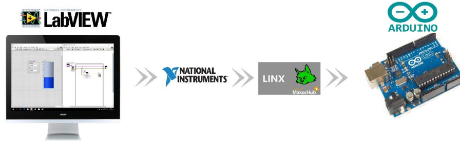
Figura 6. Diagrama a bloques del enlace entre LabVIEW y Arduino.
