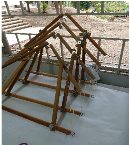
Módulos ya armados y tensados
