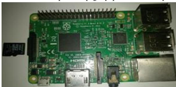
Figura 1-Raspberry Pi 3 modelo B
