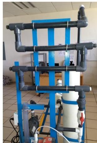
**Figura 3.** Rack corrosimétrico
