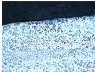
Imagen 3.5 Incrustación de boro en los límites de grano; atacada, borurada y shot-peening.
