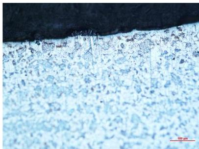
Imagen 3.4 Estructura de material atacada, borurada y shot-peening.
