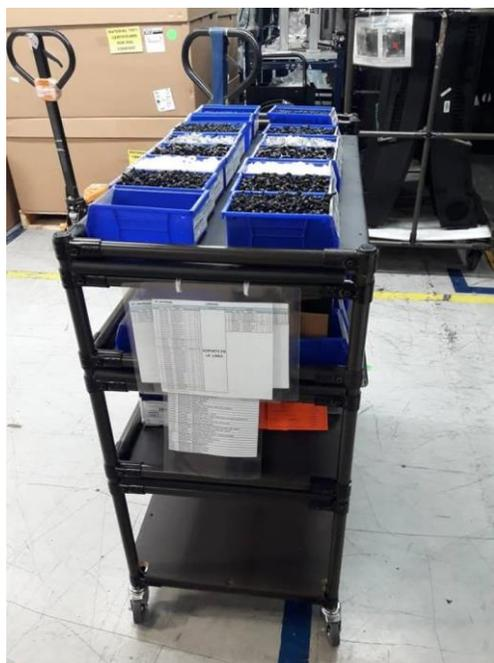
Figura 2. Carrito surtidor con bins y horario de rellenos en línea
