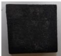
Imagen 2.3 Probeta borurada.
