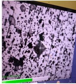
Imagen 1.3 Medición de microdureza de muestra.
