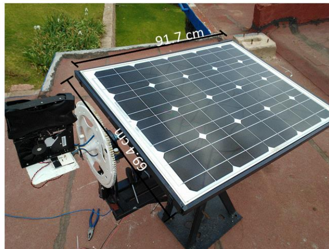
Figura 9. Dimensiones del marco para el panel solar.
