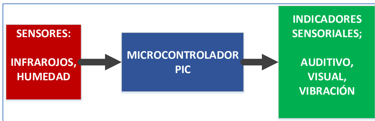
Figura 3. Diagrama a bloques del Bastón Sensor para Invidentes.
