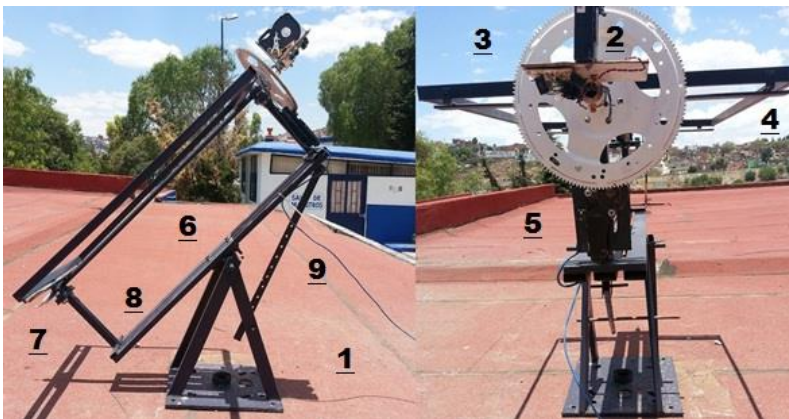
Figura 8. Partes de la estructura del seguidor solar
