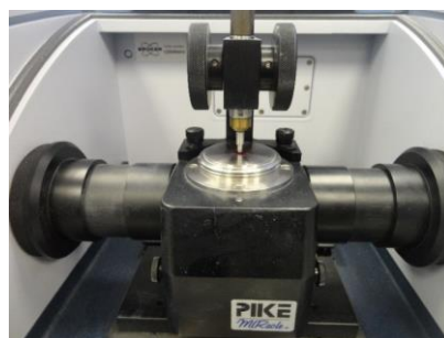
Figura 3. a) espectrofotómetro FT-IR Vertex 70v (Bruker, EUA); b) accesorio universal ATR MIRacle (PIKE Technologies, EUA) para análisis de sólidos y líquidos.
