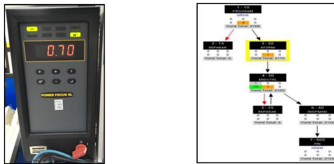
Figura 4. Torquímetro programable agregado a trazabilidad.
