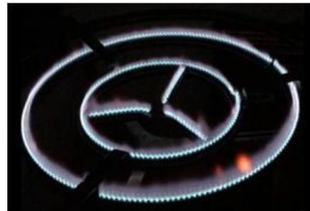
Figura 4(b). Funcionamiento con espreas de diámetro mayor.
