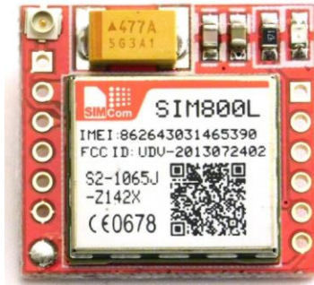
Figura 4 Muestra un Circuito Integrado GSM SIM800L.
