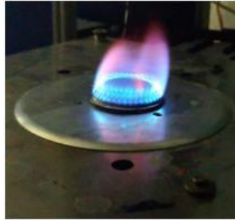
Figura 9. Funcionamiento del quemador con gas L.P.
