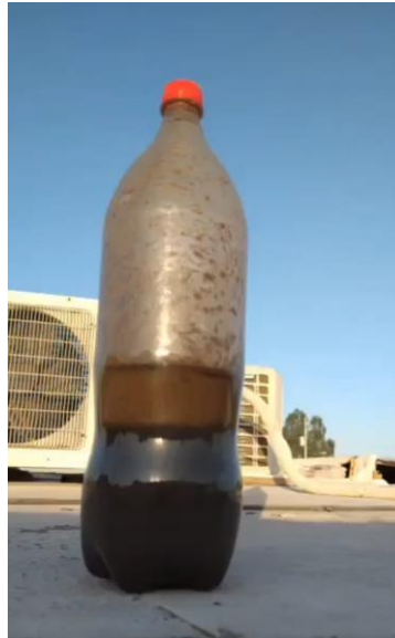
Figura 3. Recipiente usado para producir biogás
