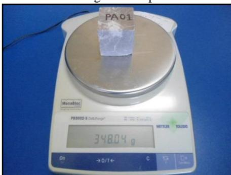
Figura 9. Fotografía del peso seco de la probeta PA01.
