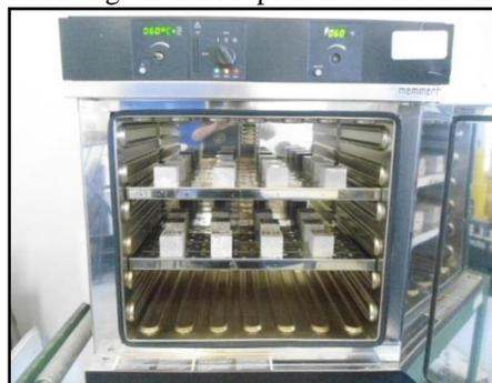
Figura 8. Fotografía de las 24 probetas dentro del horno.
