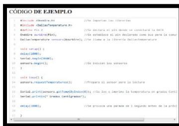
**Figura 7.-**Código de programación para sensor de temperatura
