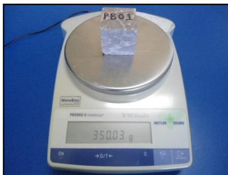
Figura 10. Fotografía del peso seco de la probeta PB01.
