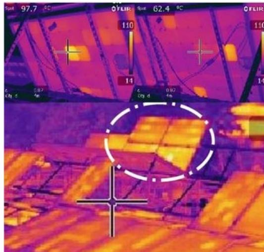
energía para lograrlo, basta con instalar reflectores en esos espacios vacíos, y servirse de modelos matemáticos de uso común para calcular el mejor modo de hacerlo, evitando de paso cambios drásticos de temperatura en los paneles. Figura. 2 Las lecturas de radiación térmica en paneles solares para mejorar los sistemas fotovoltaicos en Michigan Tech (Pearce, 2015)
