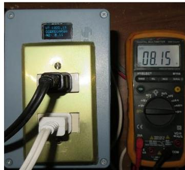
Figura 10 sobrecarga generada en el tomacorriente A1
