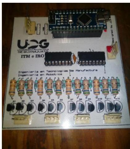
Figura 5. Placa controladora del motor.
