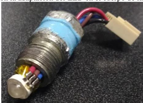
Figura 2. Adaptación de LED RGB en bujía.
