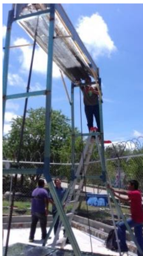
Figura 5.- Prototipo del concentrador CPC, con absorbedor colocado en el vértice de las parábolas.
