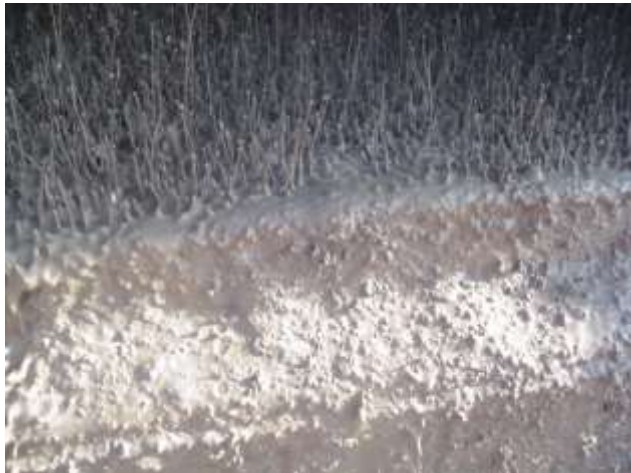
FOTO DE UN FLUIDO EN PESIMAS CONDICIONES DONDE SE OBSERVA LA FUERTE INVASION DE SOLIDOS. Y YA NO SE OBSERVA LA SEPARACION DE LOS MISMOS
