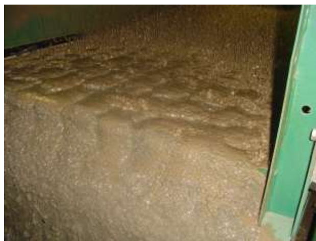
FOTO DE UN FLUIDO BASE AGUA INHIBIDO CON REOLOGIAS INVERSAS OBSERVANDOSE LA ELIMINACION DE LOS SOLIDOS
