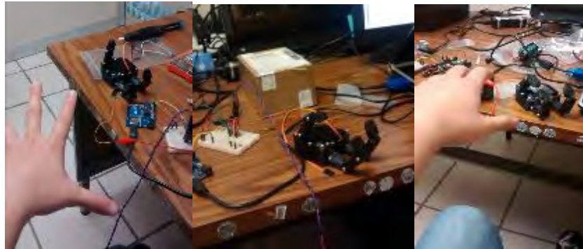
Fig. 11. Manipulación del gripper usando Arduino y la tarjeta V3
