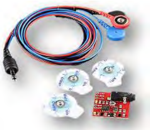
Fig. 2. Tarjeta V3 para sensores musculares.
