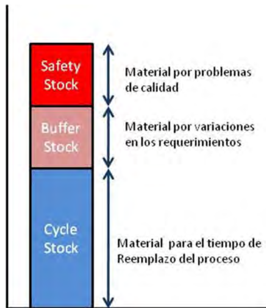
Figura 4. Modelo de cálculo de inventarios para un sistema de jalón
