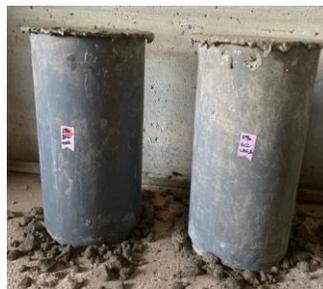
Fotografía 2. Cilindros con diferentes mezclas de concreto, utilizando cemento Apasco® y cemento Chihuahua®.
