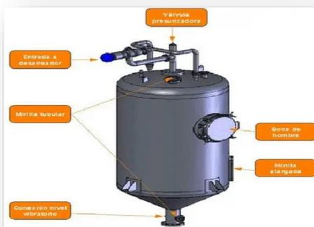
Figura. 3. Diagrama de un depósito
