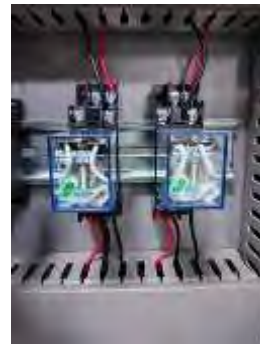
Figura 6. Relevadores conectados en el Módulo Didáctico.
