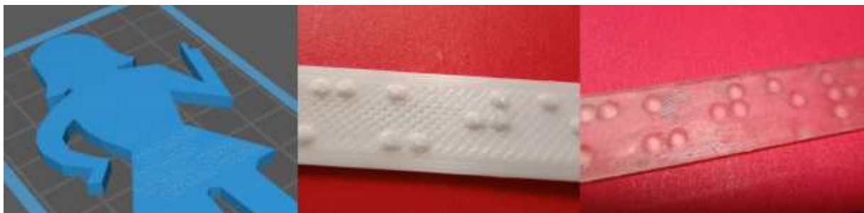
Figura 3. Caracteres Braille en FDM y MSLA
