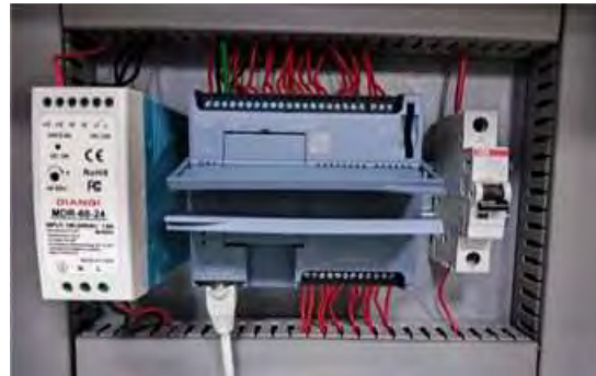
Figura 2. P.L.C. conectado en el Módulo Didáctico.
