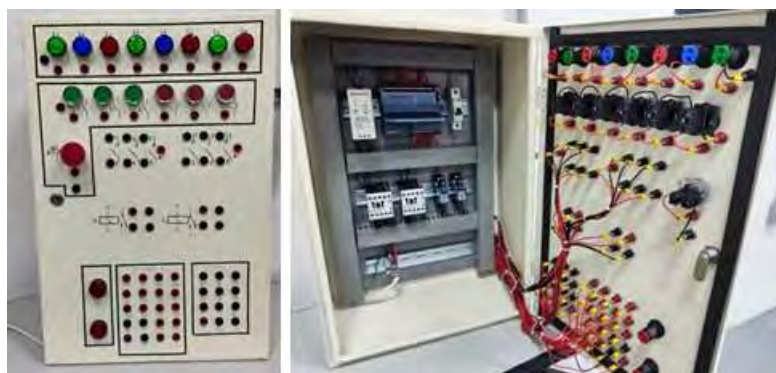
Figura 11. Módulo Didáctico para Automatización con P.L.C.
