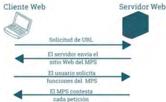
Figura 3.- Conexión Web hacia MATLAB Production Server.
