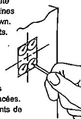
Placez le gabarit de la gâche sur le chambranle; alignez les axes avec les lignes tracées. Marquez les quatre points de centrage.
