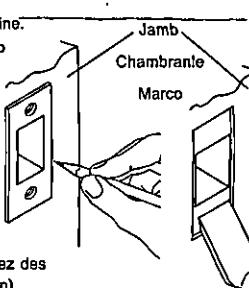
Coloque la caja de cerradura en la jamba, alinee la plancha sobre la caja de cerradura y trace el contorno. Cincéle y saque el área trazada con suficiente profundidad como para permitir la instalación de la plancha y de la caja de cerradura al ras con la jamba. Coloque la caja de cerradura y la plancha en la jamba y marque los centros de los orificios para los tornillos. Según las marcas, perfore orificios pilotos de 3/32" de diámetro y 1" (25 mm) de profundidad.
