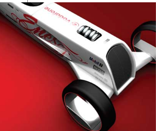
Las llantas delanteras llevan rines orbitales, para ser más ligeras y frenar mejor.
