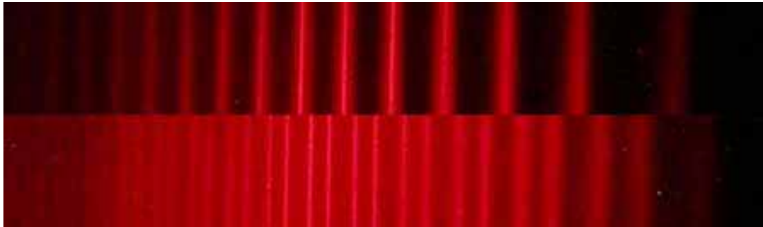
Abbildung 8: Überlagerung der Digitalaufnahmen des roten Interferenzmusters; oben ohne und unten mit Magnetfeld
