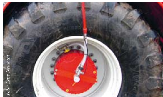
Bild 11. Omställning av däcktrycket mellan väg- och fältkörning sparar diesel.
