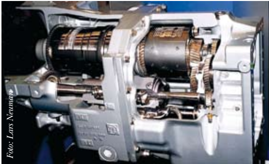
Bild 10. Den steglösa transmissionen är inte energieffektiv i sig, men tack vare bättre styrning av motor och transmission sparas ändå diesel.
