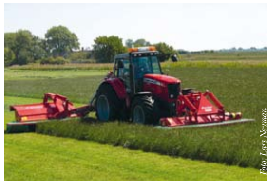
Bild 17. En slätterkross bak och en fram på traktorn utnyttjar traktorn bättre och sparar diesel.
