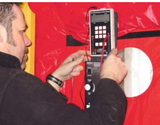
Husets lufttätthet mäts genom provtryck.
