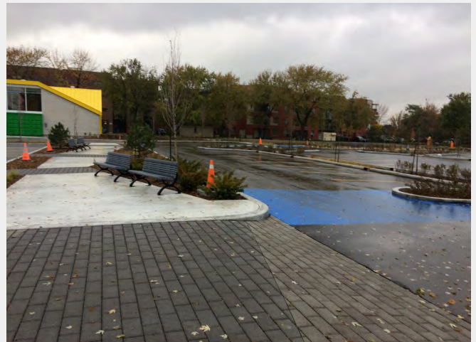
[Image de gauche : Revêtement en pavés de béton dans le stationnement du pavillon touristique de Belœil, crédit : Objectif Paysage] [Image de droite : Revêtement en pavés de béton drainants dans le stationnement de l'Aréna Rodrigue-Gilbert à Montréal, crédit : arrondissement de Rivière-des-Prairies - Pointe-aux-Trembles]
