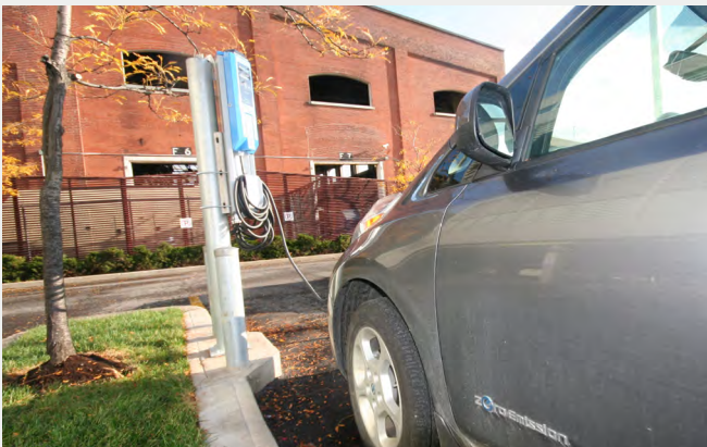
[Borne de recharge pour véhicule électrique dans le Technopôle Angus à Montréal, crédit : Société de développement Angus]
