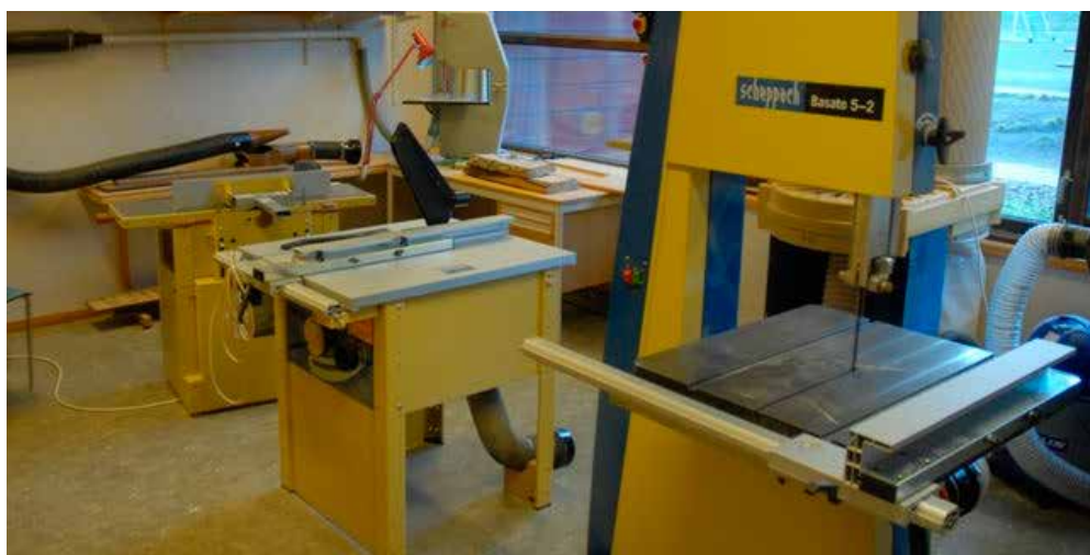
Snekkerverkstedet på Seniorsenteret har imponerende godt utstyr. Her er det meste av stasjonært verktoy båndsag, sirkelsag, høvel, dreibenk mv. samt arbeidsplasser med høvelbenker osv..
