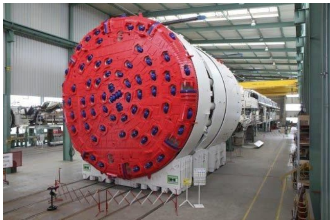
Tunnelboremaskinen «Magda Flåtestad» på Follobanen (Foto: Herreknecht)
