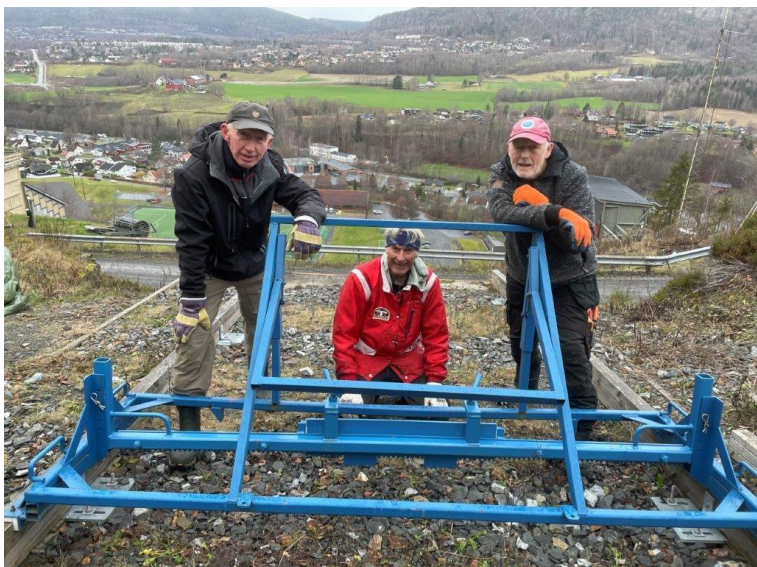
Sporsetteren har fått påmontert kam for å jevne ut snøen og skjøre for å skjøre ut skisporet. Skal prøves på snø når vi har fått montert vinsj som kan trekke den.
