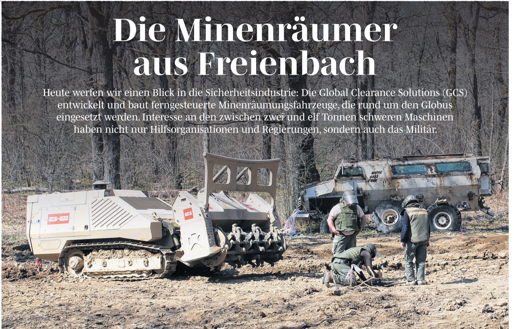
Die GCS-200 und kroatische Minenspezialisten auf einem Testgelände anlässlich der Belastungstests, die GCS Anfang April im «Croatian Mine Action Center for Testing, Development and Training» durchführte. Beim Test wurden drei Panzerminen und 19 Personenminen erfolgreich geräumt.
