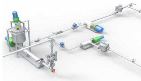
FIGURE 3: STIR POT STATIC MIXER SYSTEM
