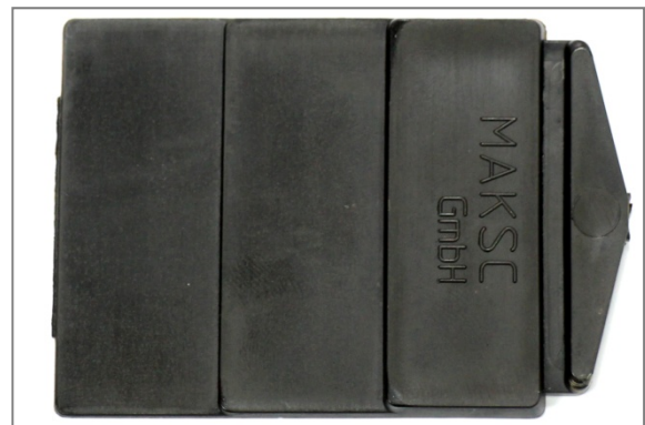
Abb. 4.4_16: Polen Netze Stufenplättchen | Fig. 4.4_16: Polen Netze staircase sample
