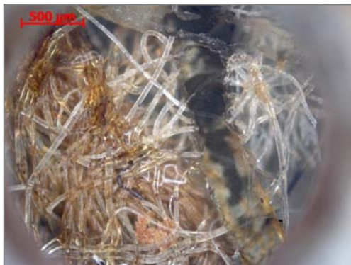
Abb. 4.5_5: Ahlbeck Netze 214 °C (10K/min) | Fig. 4.5_5: Ahlbeck Netze 214 °C (10K/min)
