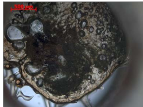
Abb. 4.3_6: Sassnitz Netze 234 °C (10K/min) | Fig. 4.3_6: Sassnitz Netze 234 °C (10K/min)
