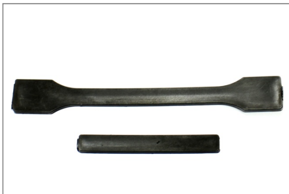
Abb. 4.4_15: Polen Netze Prüfkörper | Fig. 4.4_15: Polen Netze test specimens
