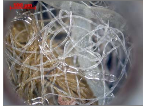
Abb. 4.5_4: Ahlbeck Netze 167 °C (10K/min) | Fig. 4.5_4: Ahlbeck Netze 167 °C (10K/min)
