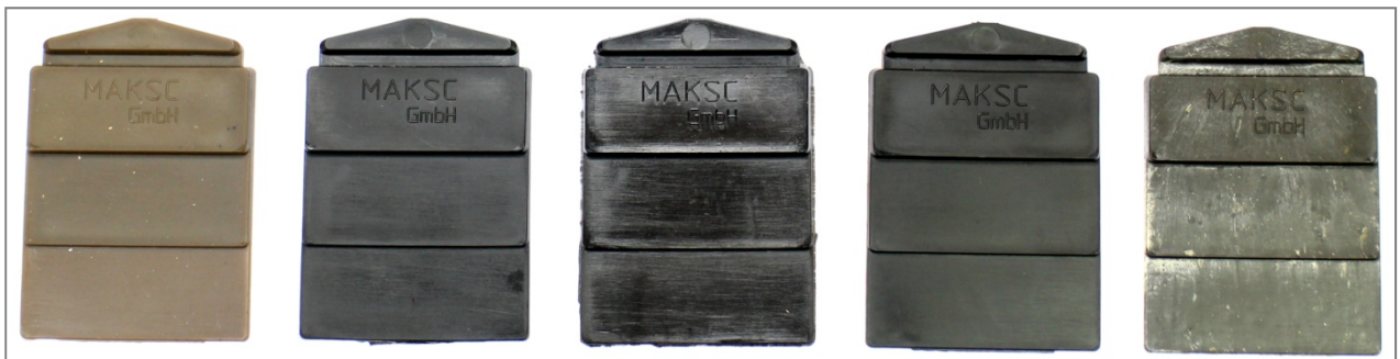
Abb. 5.1_3: Stufenplättchen von Sassnitz Tauge, Sassnitz Netze, Polen Tauge, Polen Netze und Ahlbeck Netze (v. l. n. r.) | Fig. 5.1_3: staircase sample Sassnitz Tauge, Sassnitz Netze, Polen Tauge, Polen Netze and Ahlbeck Netze (left to right)
