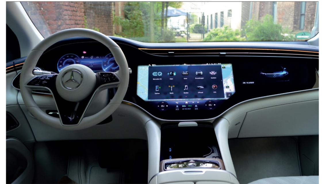
In der SUV-Variante des elektrischen Topmodells von Mercedes ist der beeindruckende „Hyperscreen“ Serienausstattung: Er kombiniert Multifunktions-, Zentral- und Beifahrerdisplay unter einer gemeinsamen Glasabdeckung, sodass sie wie ein durchgehender Bildschirm wirken. Bis auf das Kombiinstrument lassen sie sich per Touch mit haptischem Feedback bedienen. Augentracking schaltet das Beifahrerdisplay ab, falls sich der Fahrer dessen Inhalt widmet.
