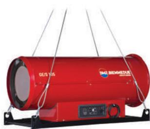
**GE/S:** in acciaio verniciato, alimentati a gasolio, con bruciatore integrato, a combustione diretta: i residui della combustione vengono espulsi con l'aria calda prodotta dal generatore e contribuiscono al suo riscaldamento, per questo motivo hanno un rendimento del 100% ovvero trasformano tutta la potenza bruciata in potenza termica resa. Sono i più economici, anche per quel che riguarda l'esercizio ma per contro possono essere impiegati solamente in locali areati.
