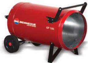
**GP:** alimentati a GPL in alta pressione (1,5 bar), con bruciatore integrato ed a combustione diretta. Sono realizzati in due versioni: ad accensione manuale (M) tramite piezoelettrico ed ad accensione automatica (A) grazie ad una apparecchiatura di controllo fiamma, che consente il collegamento di un termostato per controllare accensione e spegnimento. Per la loro alimentazione vengono in genere collegati alle bombole di GPL, il che li rende maneggevoli e molto economici.
