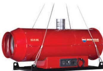
**EC/S e PHOEN/S:** in acciaio verniciato, alimentati a gasolio, con bruciatore integrato (EC) e separato (PHOEN) dal ventilatore, a combustione indiretta: impiegano uno scambiatore di calore che permette l'evacuazione dei fumi attraverso un camino collegabile con l'esterno; possono quindi essere collocati all'interno di locali chiusi, per contro hanno un costo più elevato ed un rendimento intorno al 90% dovendosi calcolare, in riduzione la quantità di calore evacuata attraverso il camino.
