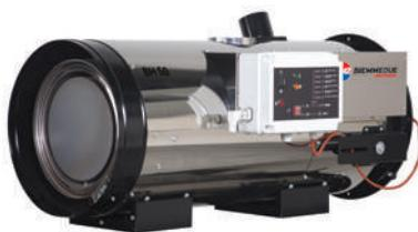
**BH:** in acciaio inox, a combustione indiretta, dotati di bruciatore esterno, sono disponibili sia nella versione gasolio che nella versione GPL e metano. Di forma circolare, sono molto compatti ma al tempo stesso facilmente ispezionabili grazie alla particolare soluzione per l'accesso al bruciatore. Per tutti i modelli è prevista di serie l'attacco snorkel per la presa d'aria dall'ambiente esterno in modo tale da garantire una perfetta combustione.
