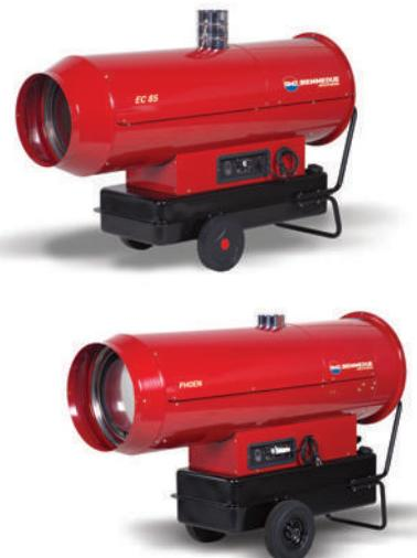
**EC e PHOEN:** alimentati a gasolio, con bruciatore integrato (EC) e separato (PHOEN) dal ventilatore, a combustione indiretta: impiegano uno scambiatore di calore che permette l'evacuazione dei fumi attraverso un cammino collegabile con l'esterno; possono quindi essere collocati all'interno di locali chiusi, per contro hanno un costo più elevato ed un rendimento intorno al 90%, dovendosi calcolare, in riduzione, la quantità di calore evacuata attraverso il cammino.
