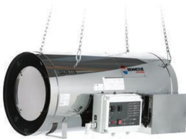
**GA/N:** in acciaio inox, alimentabili a GPL o metano in bassa pressione (20-30 mbar), con bruciatore integrato ed a combustione diretta. Possono essere facilmente pilotati da un'unità di controllo esterna. A differenza del modello GA, funzionando a bassa pressione, possono essere sempre installati internamente, indipendentemente dalla normativa di riferimento in vigore.
