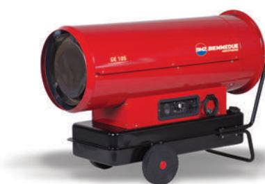
**GE:** alimentati a gasolio, con bruciatore integrato, a combustione diretta: i residui della combustione vengono espulsi con l'aria calda prodotta dal generatore e contribuiscono al suo riscaldamento, per questo motivo hanno un rendimento del 100% ovvero trasformano tutta la potenza bruciata in potenza termica resa. Sono i più economici, anche per quel che riguarda l'esercizio ma per contro possono essere impiegati solamente in locali areati.
