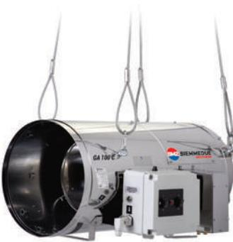
**GA:** in acciaio inox per resistere meglio agli agenti corrosivi tipici degli allevamenti, alimentato a GPL in alta pressione (1,5 bar), con bruciatore integrato ed a combustione diretta. E' dotato di accensione automatica, grazie ad una apparecchiatura di controllo fiamma che consente il collegamento ad un termostato o climat computer per controllare accensione e spegnimento; è la macchina più economica per il riscaldamento di serre ed allevamenti.
