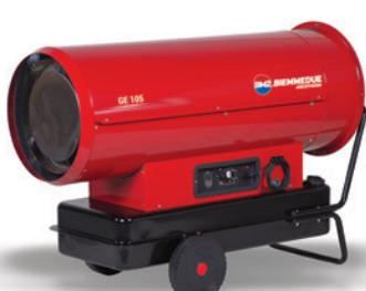
**GE:** alimentati a gasolio, con bruciatore integrato, a combustione diretta: i residui della combustione vengono espulsi con l'aria calda prodotta dal generatore e contribuiscono al suo riscaldamento, per questo motivo hanno un rendimento del 100% ovvero trasformano tutta la potenza bruciata in potenza termica resa. Sono i più economici, anche per quel che riguarda l'esercizio ma per contro possono essere impiegati solamente in locali areati.
