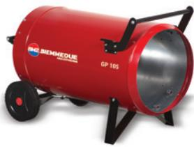
**GP:** alimentati a GPL in alta pressione (1,5 bar), con bruciatore integrato ed a combustione diretta. Sono realizzati in due versioni: ad accensione manuale (M) tramite piezoelettrico ed ad accensione automatica (A) grazie ad una apparecchiatura di controllo fiamma, che consente il collegamento di un termostato per controllare accensione e spegnimento. Per la loro alimentazione vengono in genere collegati alle bombole di GPL, il che li rende maneggevoli e molto economici.
