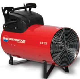
**EK:** di struttura simile ai modelli GP, sono alimentati a corrente elettrica. Infatti, in sostituzione del bruciatore vi sono delle resistenze elettriche le quali garantiscono il riscaldamento dell'aria, che viene convogliata mediante il ventilatore. Questa caratteristica li rende idonei all'impiego in qualsiasi condizione, anche nei locali chiusi, per contro la potenza termica è limitata e vengono preferibilmente impiegati ove l'energia elettrica è disponibile a basso costo.
