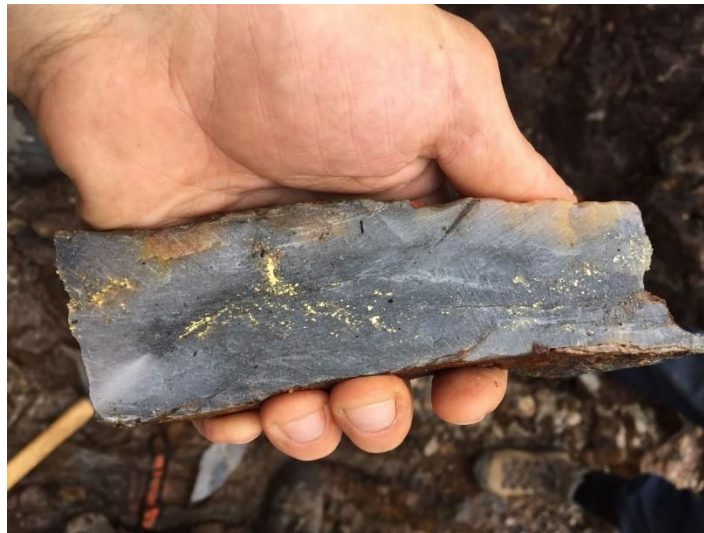
Sichtbares Gold im Channel Sample MCH225702 Metallische Siebprobe: 3310 g/t Au über 1,0 m
