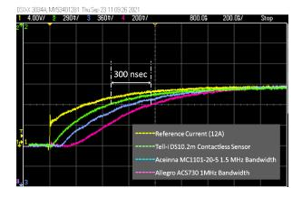
Figure 1. Comparison of DS10.2m vs other sensors
