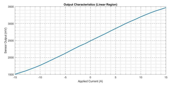
Figure 4. Output Characteristics of the sensor DS10.2m
