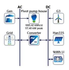
FIGURE 7: HOMER COMPONENT SCHEMATIC FOR SITE B – PIVOT PUMP HOUSE
