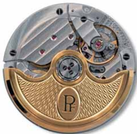
Le calibre 4000 de Vaucher Manufacture Fleurier
