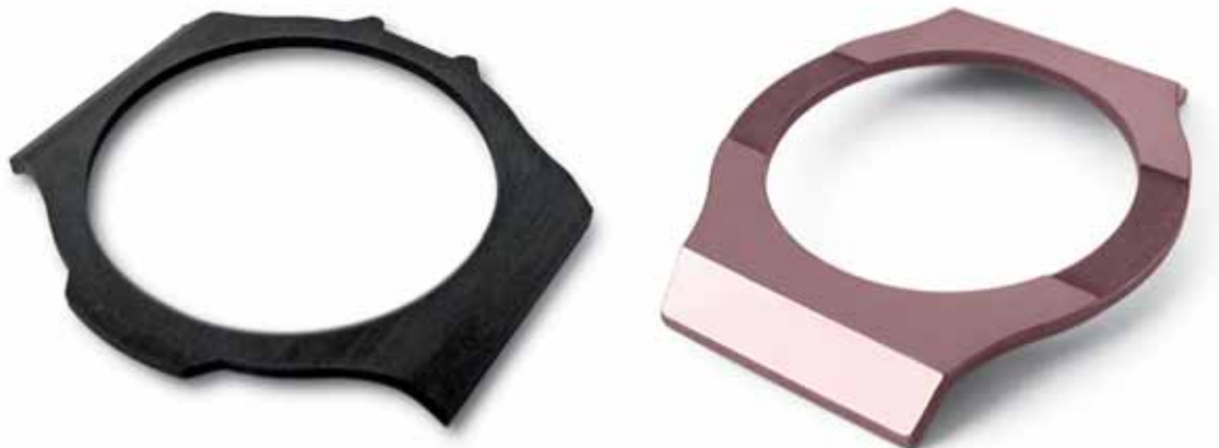
Eine Lünette aus « Magic Gold » im Rohzustand, vor und nach dem Polieren.
