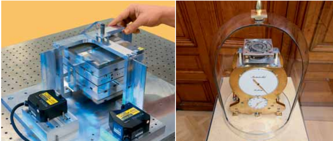
Links: IsoSpring beruht auf physikalischen Eigenschaften im Zusammenhang mit der Gravitation, angewandt auf Federklingen. Diese Erfindung eines Labors der EPFL muss noch verkleinert werden. Rechts: Der Oszillator funktioniert ohne Hemmung.
