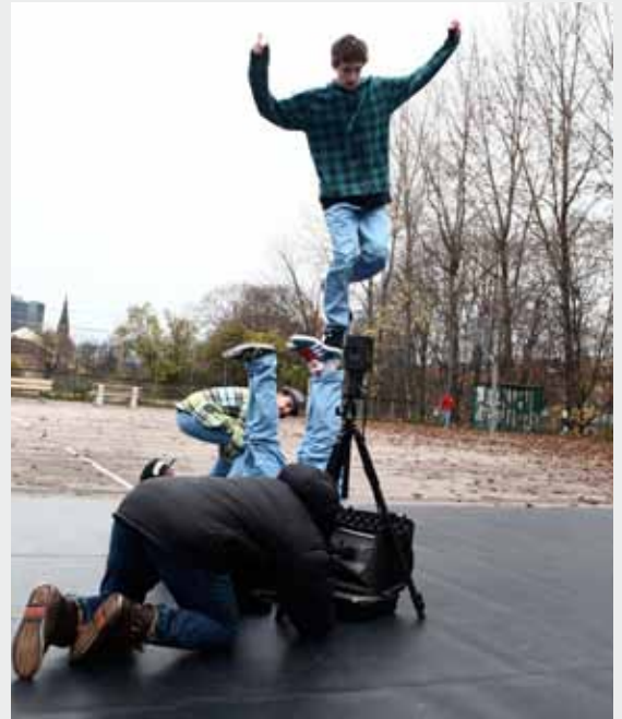
Kameraet er et prismehus med seks linser. Fem peker horisontalt 360 grader, og en peker opp eller ned, alt ettersom hva kameraet er festet til. I etterarbeidsprosessen settes disse bildene sammen, der høyeste oppløsning er 5400x3700 pixler.
