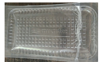
Bild 3: Typischer Ausformungsfehler bei PP Unterfolie
