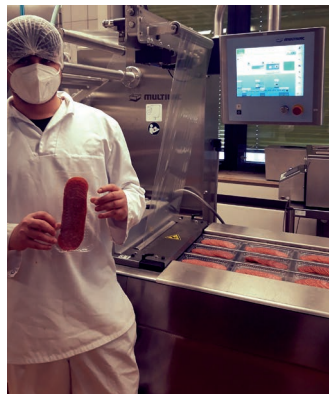
Salami MAP-Verpacken 80g mit Multivac-Tiefziehmaschine R145
