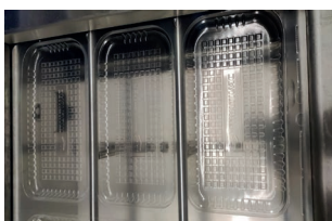
Bild 2: APET-Unterfolie nach der Ausformung
