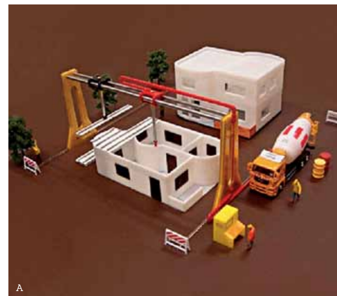
A. Le Contour Crafting en R&D depuis 2007 aux États-Unis. Vue de l'unité de construction sur site « Printed House ».
