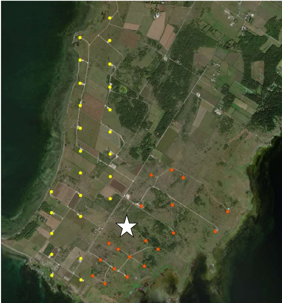
Figur 1. Karta över Näsuddens vindkraftspark där 44 av 49 verk är utmarkerade. Gula cirklar motsvarar vindkraftverk som byggdes vid generationsskifte av västra Näsudden medan orange cirklar motsvarar vindkraftverk som varit med längre och som ingår i det planerade generationsskiftet av östra Näsudden. Fem nyare vindkraftverk saknas på kartan men de ligger i förlängningen norrut av den östligaste raden med gulmarkerade verk. Vit stjärna visar platsen för IDF-enheten.
