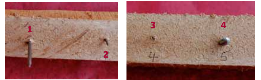
Figura 18. 1) clavado 2 pulgadas con cabeza, 2) clavado 1 pulgada con cabeza, 3) perforación para guiar un tornillo usando taladro (flecha), 4) atornillado de pija de 2 pulgadas usando taladro.
