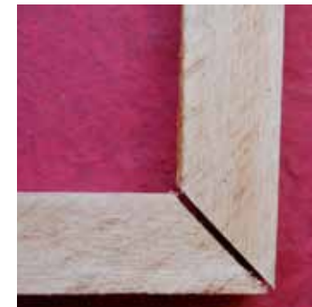
Figura 23. Ensamblaje corte 45 grados.
