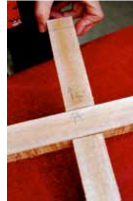
Figura 21. Ensamblaje de cruz.
