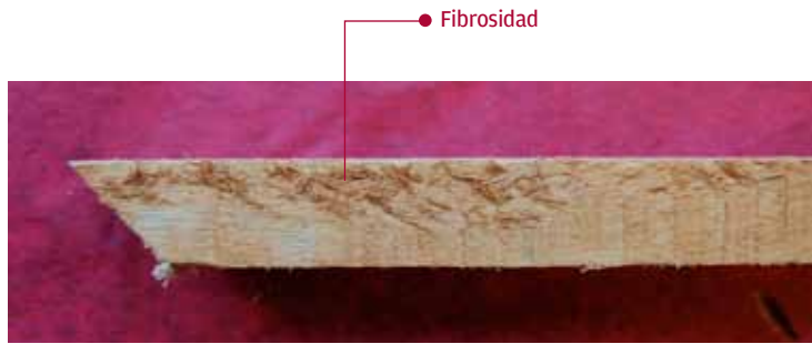
Figura 15. Desprendimiento de fibras al cepillarse.
