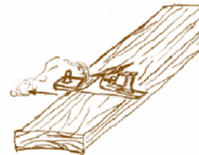
Figura 13. Cepillado atravesando el hilo.
