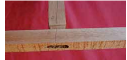
Figura 22. Ensamblaje de espiga con escoplo.
