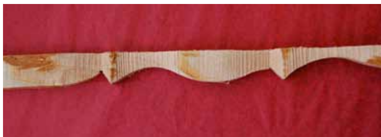
Figura 11. Bordes redondeados usando sierra cinta.
