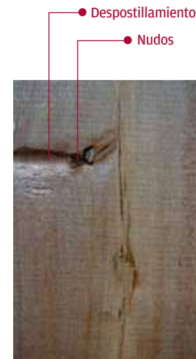
Figura 9. Cepillado con máquina.
