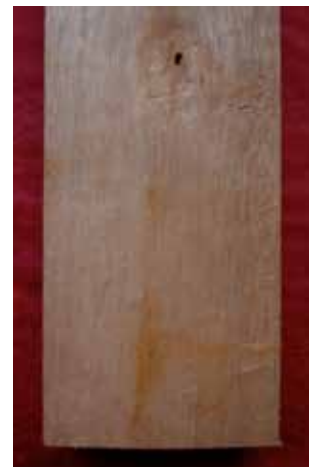
Figura 12. Resultado del cepillado manual al hilo.
