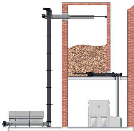
Förrådsutrymmet befinner sig ovanför pannrummet
