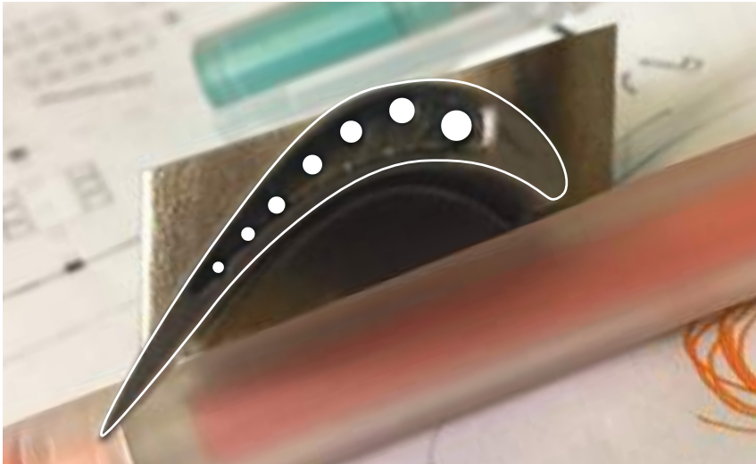
Aube mobile de turbine d'un moteur à réaction Safran-Snecma. Des conduits présents à l'intérieur permettent de faire passer un flux d'air frais et de rafraîchir l'aube qui s'échauffe sous l'action du frottement de l'air.
