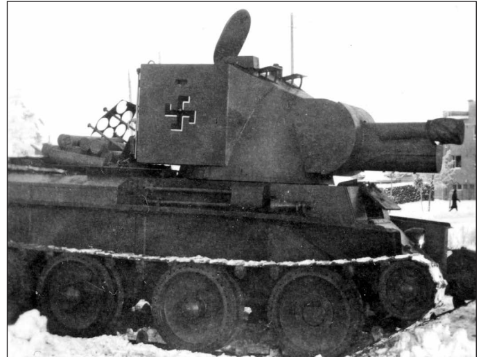
BT-42 R-708 talvella 1943. Takakannella on nähtävissä vaunun sisälle sijoitetut ammustelineet sekä hankalasti käsiteltävät ammusten kuljetusputkit.
